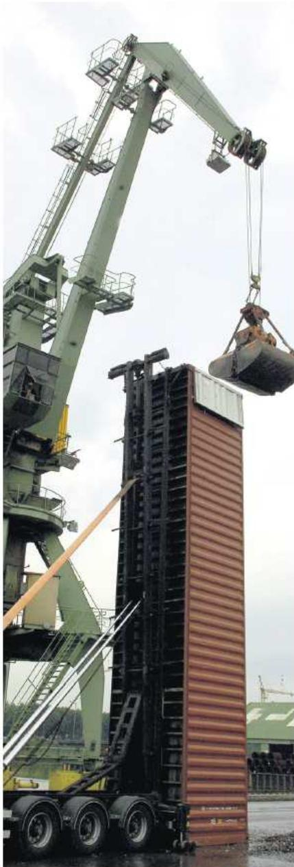
Den 40-Fuß-Container belädt der Hafekran in 20 Minuten mit Kunststoffschredder. RN-Foto Goldstein
